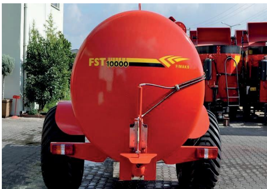
IMAGINEA 6 : Dispozitivul de împrăștiere din spate
