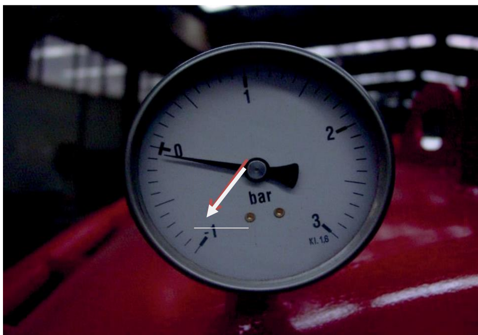
IMAGINEA 4 : Manometru care arată aspirația
